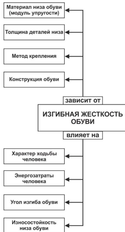
Рисунок 2.19 Факторы, определяющие изгибную жесткость обуви [93]
